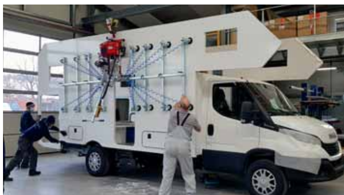
Ein Saugheber erleichtert das Handling der Platten und damit die Montage der Seitenwände.
