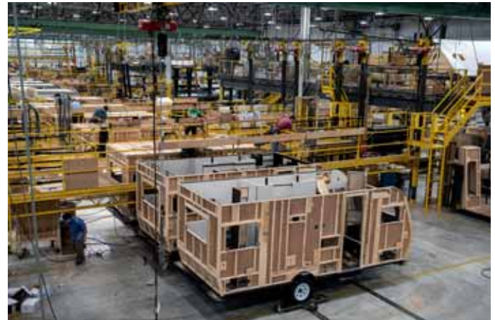
Beim Blick in die Jayco-Produktion überrascht, dass amerikanische Wohnwagen noch in traditioneller Aufbautechnik mit Holzrahmen gefertigt werden.
