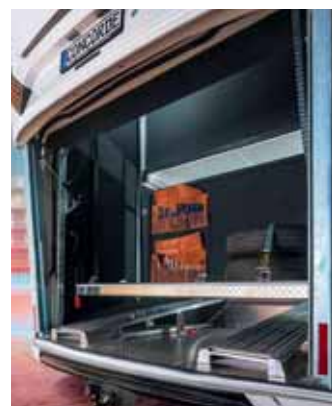
Alles an Bord: Der Garagen-Lift kann bei Bedarf für Ersatzräder oder Werkzeugkasten oder alternativ auch als Fahrradträger mit bis 80 Kilogramm belastet werden.
