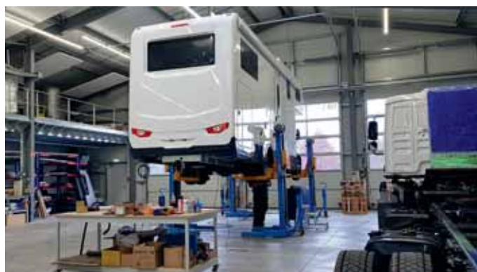
Die Vier-Säulen-Hebebühne ermöglicht Arbeiten am Unterboden und an den Schürzen der Phoenix-Reisemobile.
