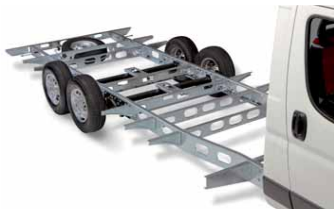
So sieht es unter zahlreichen Reisemobil-Dreiachsern aus. Al-Ko liefert das passende Chassis.
