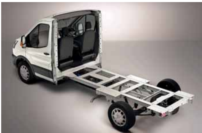
Das Tiefrahmenfahrgestell des Ford Transit ist ein ideale Basis für den Aufbau von Reisemobilen.
