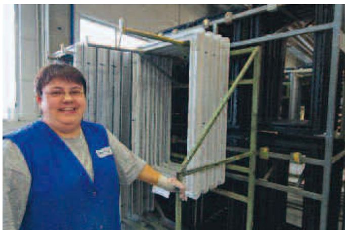
Die Rahmen der Dometic Seitz-Fenster werden auf Gestellen für die Weiterverarbeitung gesammelt.
