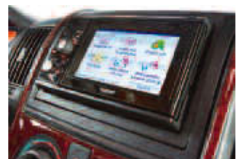
Steuereinheit: Das Eclipse-DVD/CD-Radio enthält ein mobiles TomTom-Navigationsteil.
